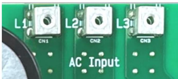
図 4.1 3相 AC 入力端子 (CN1, CN2, CN3)
