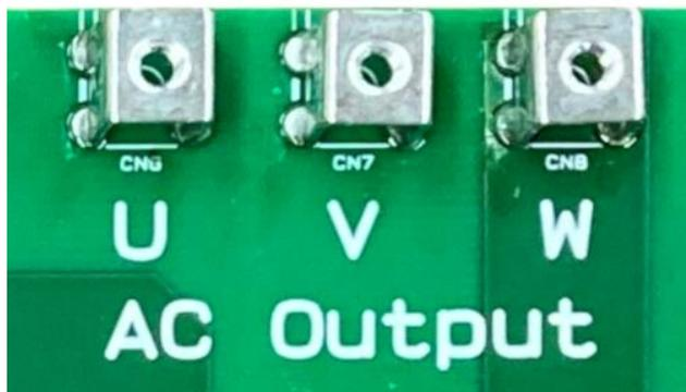
図 4.6 AC 電源出力端子 (CN6, CN7, CN8)
