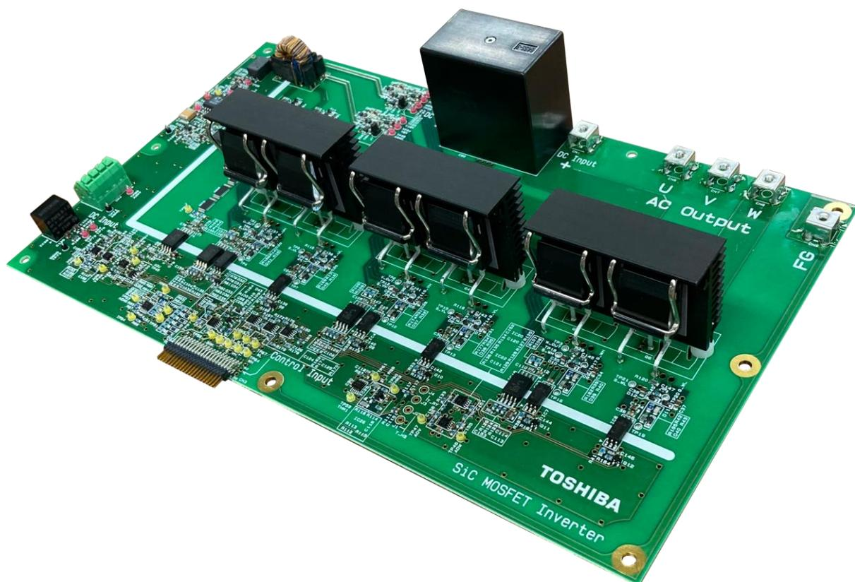
図 2.5 SiC MOSFET 応用 3 相インバーター基板 (インバーター基板, TW045N120C 搭載)側面外観
