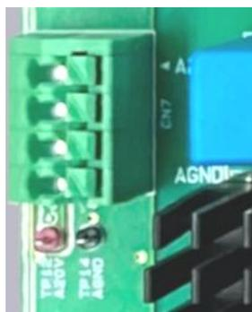
図 4.4 制御電源出力端子 (CN7)
