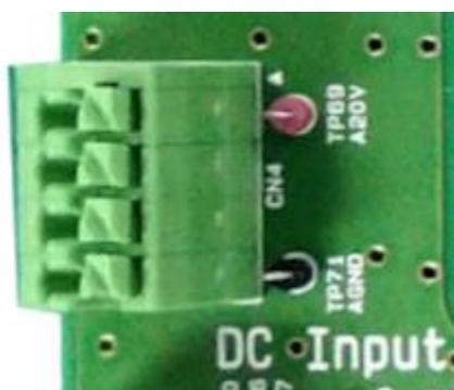
図 4.8 制御電源出力端子 (CN4)
