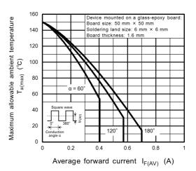
Fig. 10.4  $T_{a(max)} - I_{F(AV)}$
