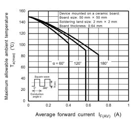
Fig. 10.3  $T_{a(max)} - I_{F(AV)}$
