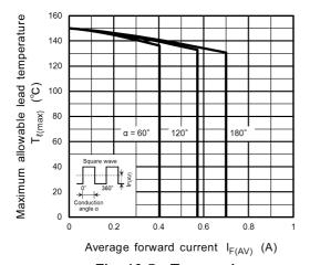
Fig. 10.5  $T_{\ell(max)}$  -  $I_{F(AV)}$
