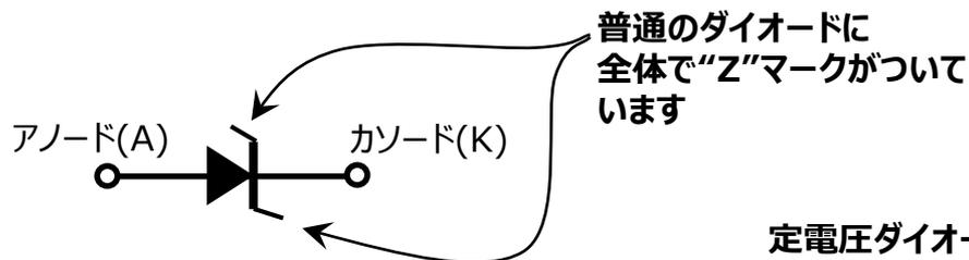
図2-4(b) 定電圧ダイオードの記号
