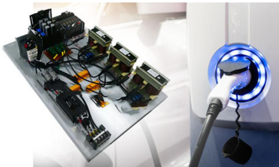
このリファレンスデザインは SiC MOSFET を使用して電源効率を改善する方法を提示しています。97%以上の電力変換効率と、0.99以上の力率を実現しています。電気自動車 (EV) の採用が進むにつれて高効率で小型の電力変換システムの需要が高まっている充電システムなどの高電力コンバーターの PFC 部 (ゲート駆動回路、センサー回路、出力パワースイッチ) のリファレンスデザインとしてご使用いただけます。
