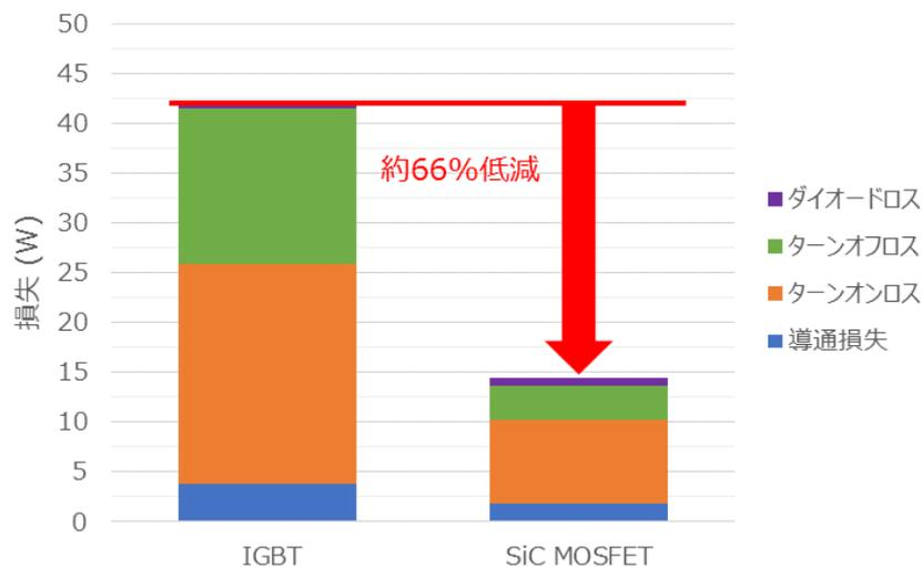
図 5: SiC MOSFET と IGBT の各損失と総和の比較例
