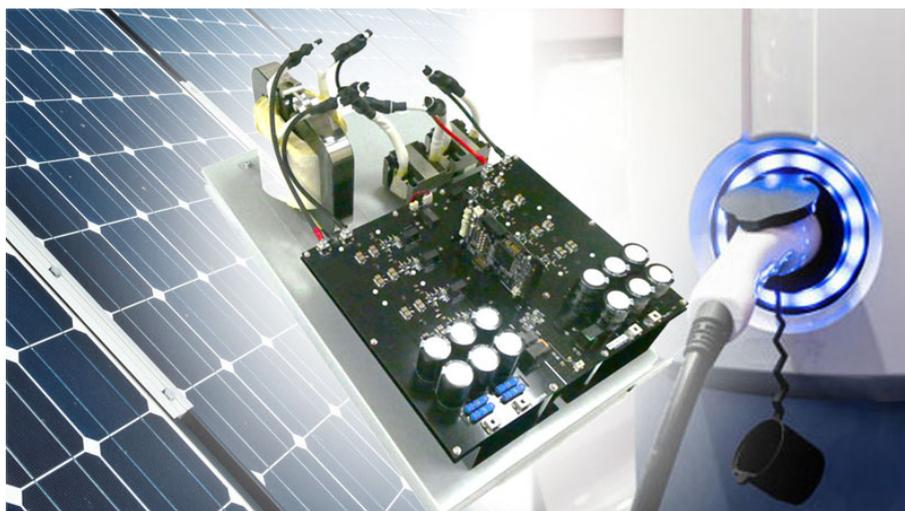
このリファレンスデザインは、大電力変換用途において注目されている方式の1つであるデュアルアクティブブリッジ (DAB) 方式を採用した絶縁双方向 DC-DC コンバーターです。SiC MOSFET を採用することで大電力変換と高効率化の両立が可能になります。このリファレンスデザインの利用により、電気自動車 (EV) の充電システムや太陽光発電用インバーターなどのシステム開発を迅速かつ簡単に進めることが可能です。
