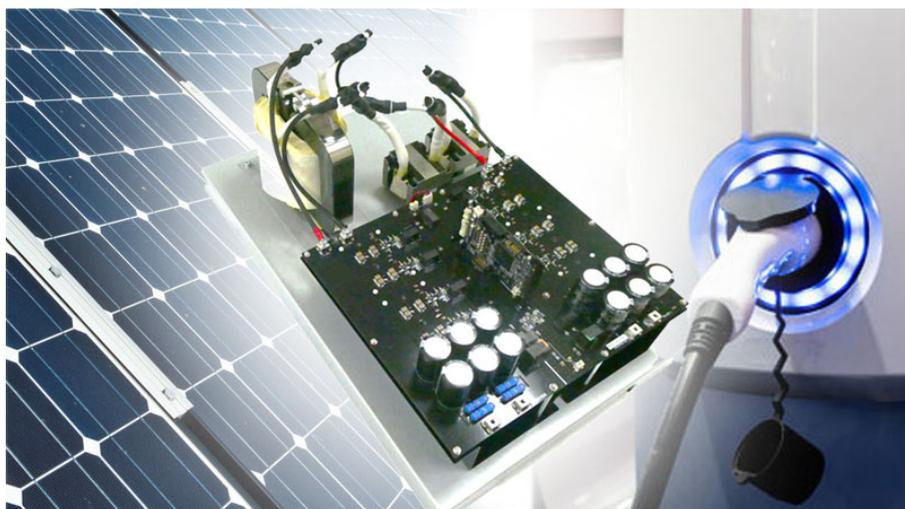
このリファレンスデザインは、大電力変換用途において注目されている方式の1つであるデュアルアクティブブリッジ (DAB) 方式を採用した絶縁双方向 DC-DC コンバーターです。SiC MOSFET を採用することで大電力変換と高効率化の両立が可能になります。このリファレンスデザインの利用により、電気自動車 (EV) の充電システムや太陽光発電用インバーターなどのシステム開発を迅速かつ簡単に進めることが可能です。
