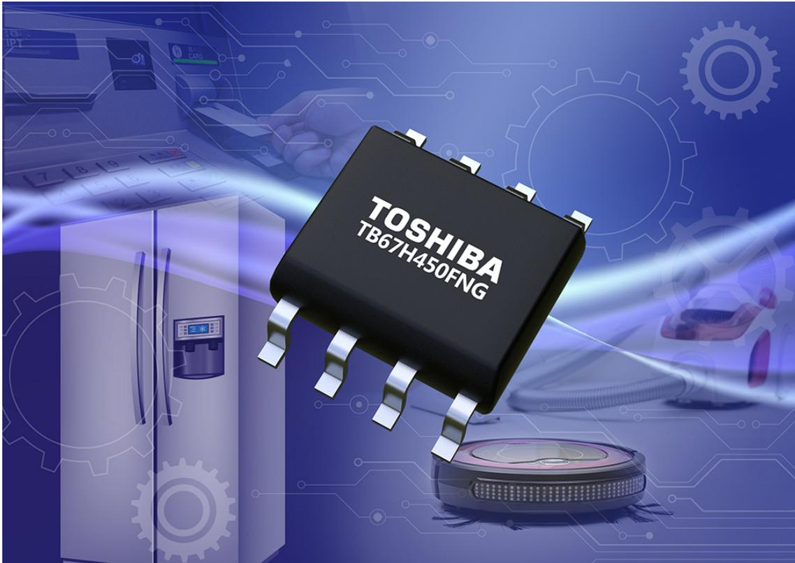
**Toshiba lancia un IC driver compatto e ad alta efficienza per motori con spazzole nella comune piedinatura del package HSOP8**
