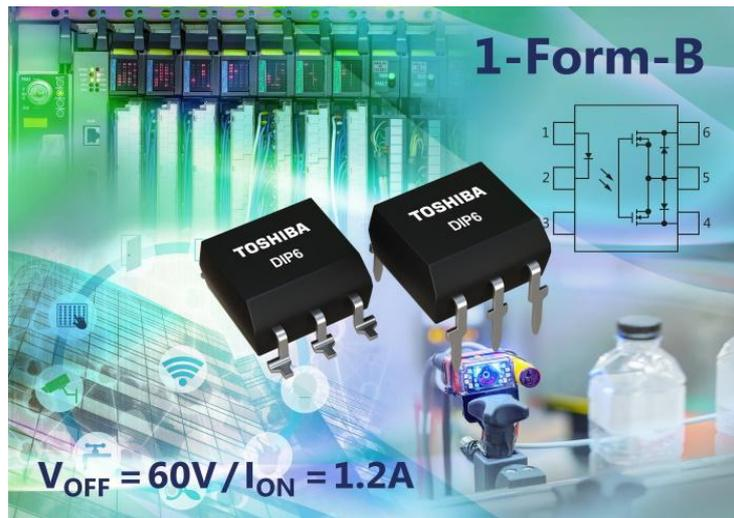
**Il nuovo fotorelè 1-Form-B di Toshiba offre una corrente nominale di 1,2A per lo stato di on.**
