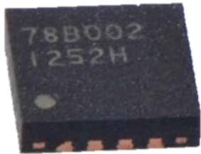
WQFN16 Package (3 mm×3 mm×0.75 mm)
