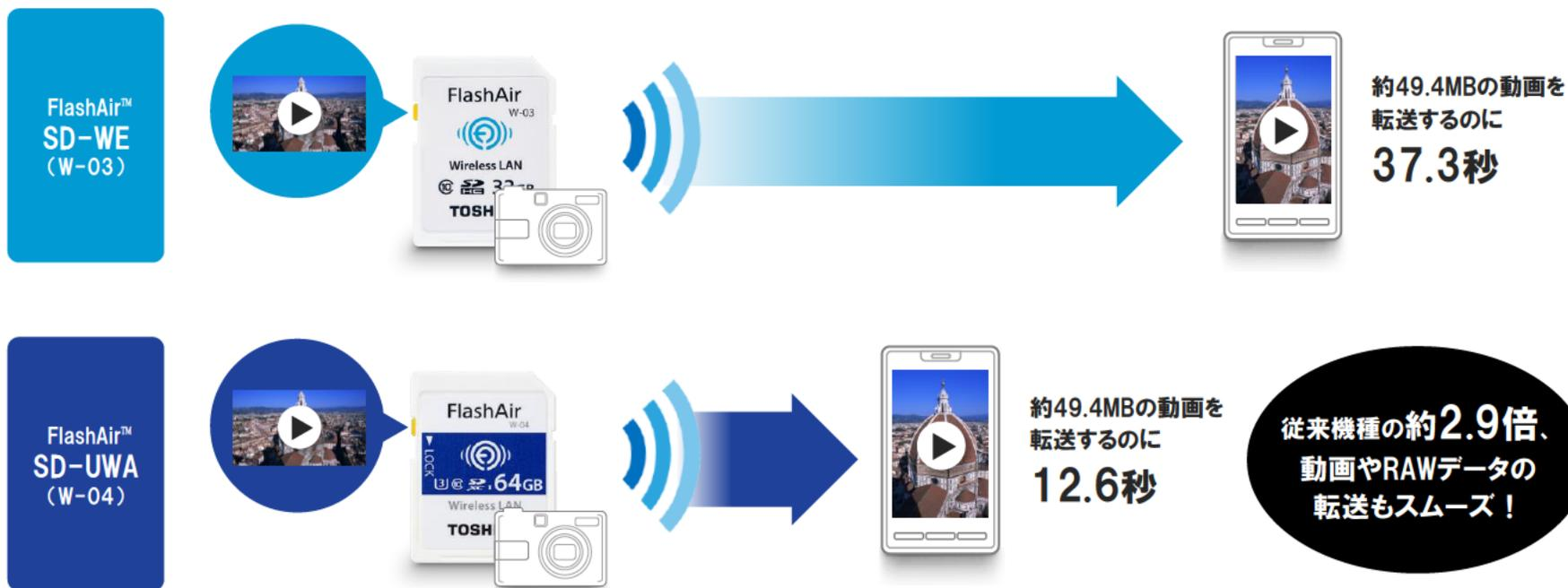
\*2) カメラ：IXY 100F(キヤノン製)、スマートフォン：iPhone 7、測定方法：シールドルーム内で「FlashAir™ SD-WE032G(W-03)」/「FlashAir™ SD-UWA064G(W-04)」を挿入したカメラとスマートフォンを50cm離し、スマートフォンへのファイルダウンロードの開始から終了までの時間をストップウォッチで計測。送信ファイルサイズ：49.4MB=51,799,654.4byte (動画)、送信ファイル数：1個。使用される機器や環境によって無線送信速度は異なります。弊社で無線送信を計測した環境、および速度測定結果は上記のとおりです。これらの測定値は弊社独自で計測したものであり実際の送信速度を保証するものではありません。
