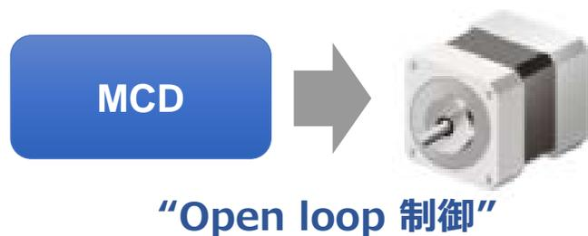
通常、最大負荷時のモータ脱調に備え、**ピーク電流にマージンを取った定電流値**に設定。
