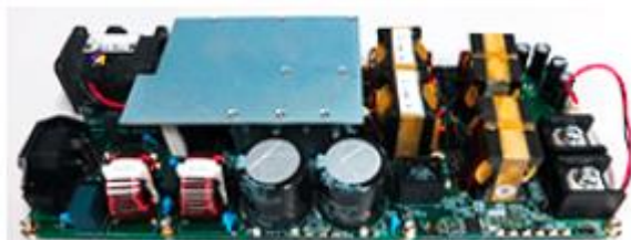
1.6kW スwitchング電源(80Plus Platinum級)リファレンスボード
