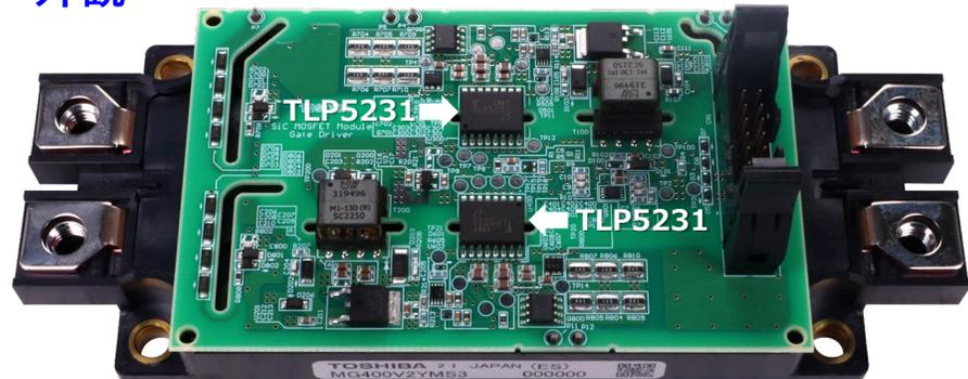
・SiC MOSFETモジュールの直上にゲートドライバー基板を嵌合した状態
