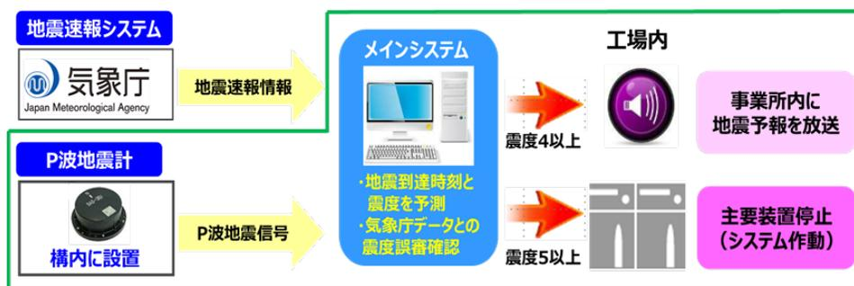
図 3. 装置安全停止システム
