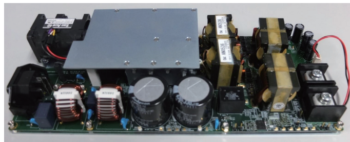
リファレンスデザインセンター内で公開している「1.6kW, 80Plus Platinum 級、高効率 AC-DC サーバー用電源」の制作例
