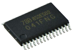
SSOP30-P-300-0.65パッケージ (10.2 x 7.6 x 1.6 mm)
