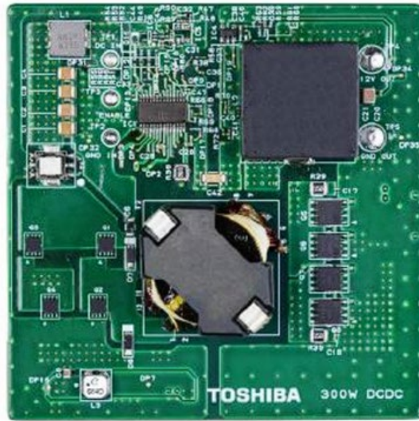
図 1. 300W DC-DC コンバーターの 2 次側損失を解析するための物理評価回路
