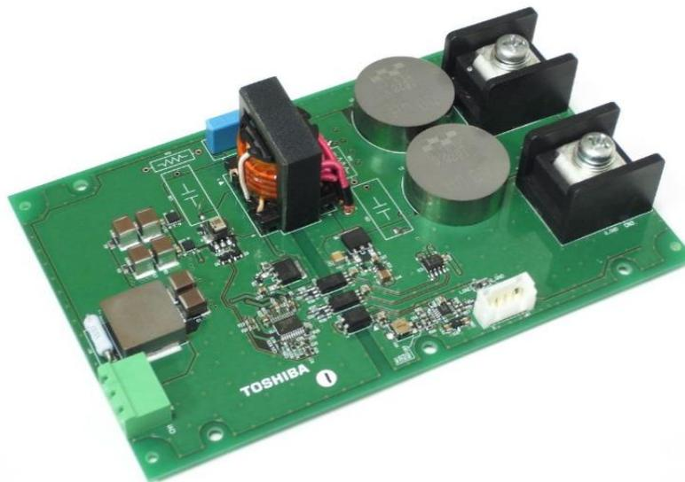
図 4. 48 V バスシステムをサポートするハーフブリッジ DC-DC コンバーターリファレンスデザイン
