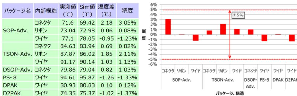
図 3. MOSFET 温度の実測値とシミュレーション値との比較
