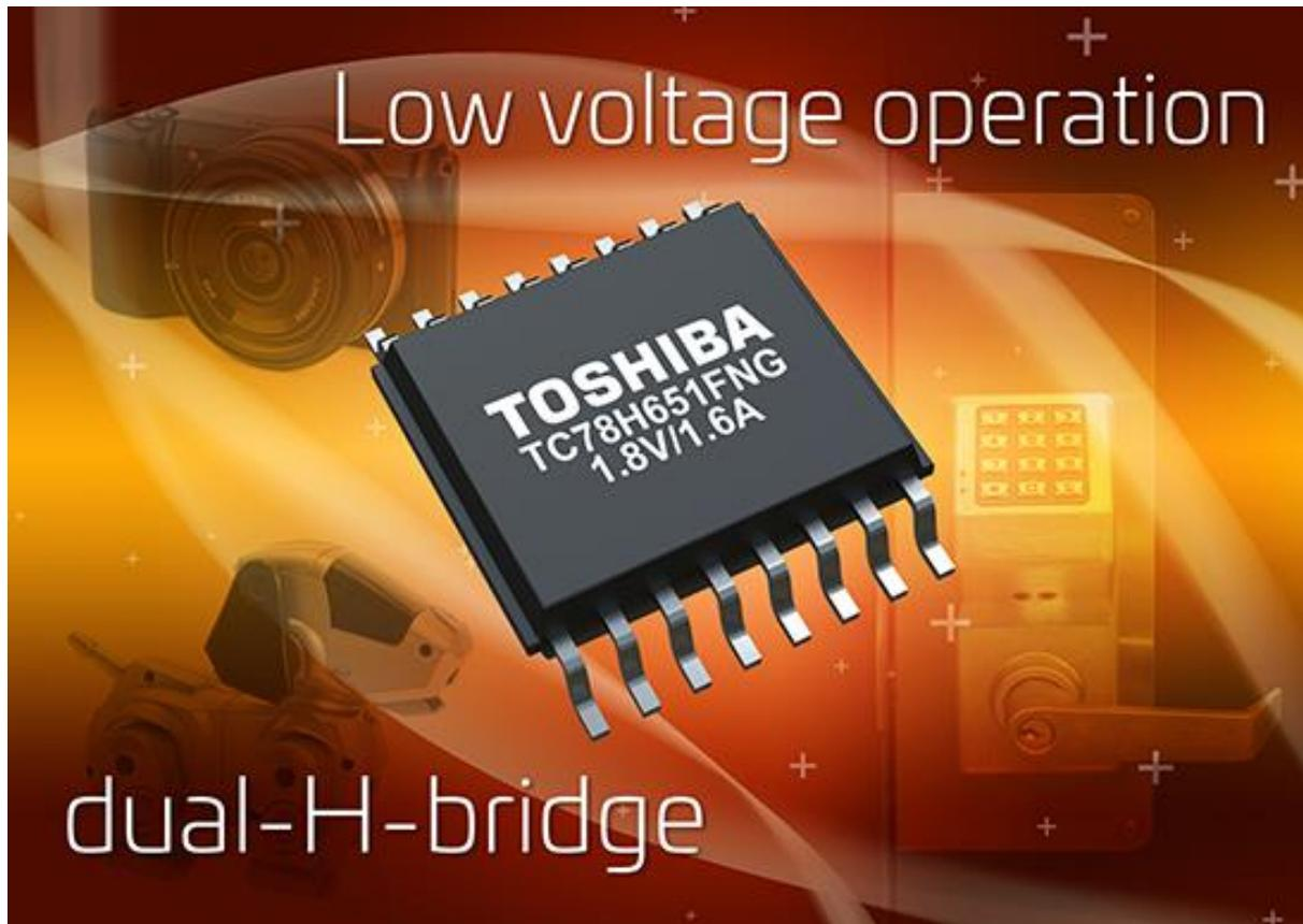
**Driver de moteur Toshiba à pont en H pour applications basse tension à courant élevé**
