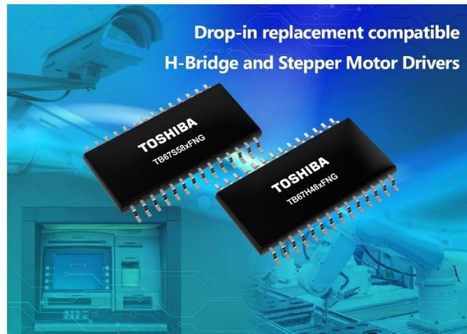
**I circuiti integrati per azionamento motore da 50 V di Toshiba riducono il numero di componenti, fanno risparmiare spazio su scheda e permettono di attuare strategie di second sourcing**
