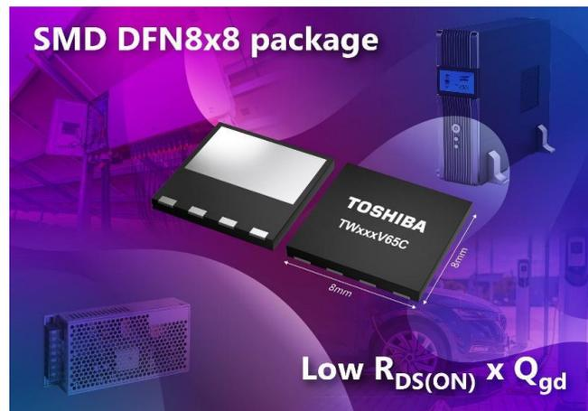
**Les MOSFET SiC ultra-compacts de Toshiba, en boîtier DFN8x8 de 650 V, améliorent la densité de puissance et l'efficacité des équipements industriels.**
