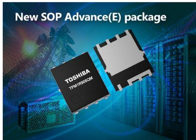
**Gehäuse der nächsten Generation für Leistungs-MOSFETs verringert erheblich den Einschalt- und Wärmewiderstand**
