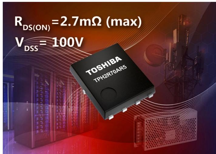
**Toshiba bringt neuen 100-V-MOSFET mit 2,7 mΩ in einem 5,15 x 6,1 mm kleinen Gehäuse auf Grundlage des U-MOS11-H-Prozesses auf den Markt**
