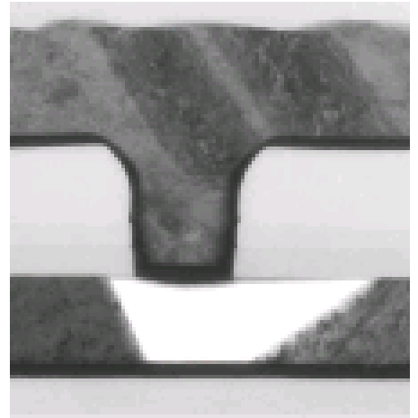
図 2-1-6-1 CuプロセスのVia下部に発生したボイドの観察像
