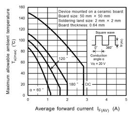
Fig. 10.3  $T_{a(max)} - I_{F(AV)}$
