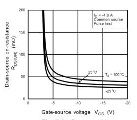
Fig. 7.3 R<sub>DS(ON)</sub> - V<sub>GS</sub>
