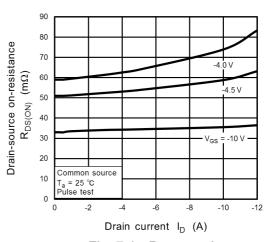
Fig. 7.4 R<sub>DS(ON)</sub> - I<sub>D</sub>
