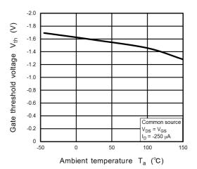
Fig. 7.6 V<sub>th</sub> - T<sub>a</sub>
