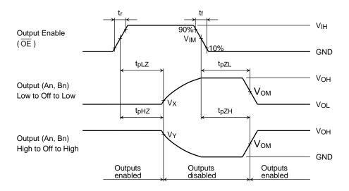
Figure 3 t<sub>pLZ</sub>, t<sub>pHZ</sub>, t<sub>pZL</sub>, t<sub>pZH</sub>
