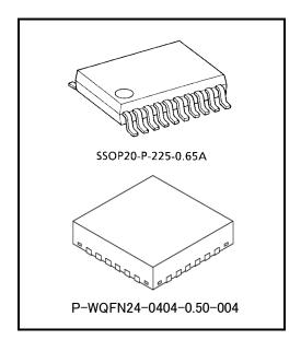
Weight: SSOP20-P-225-0.65A 0.09g(typ.) P-WQFN24-0404-0.50-004 0.03g(typ.)
