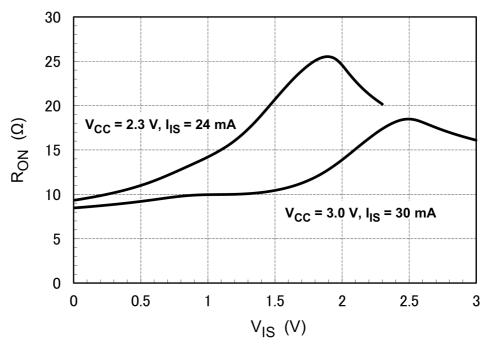
Fig. 13.1  $R_{ON}$  -  $V_{IS}$  (typ.) ( $T_a = 25$  °C)
