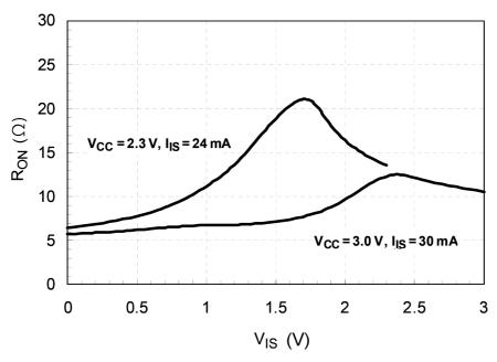
Fig. 13.1  $R_{ON}$  -  $V_{IS}$  (typ.) ( $T_a = 25$  °C)
