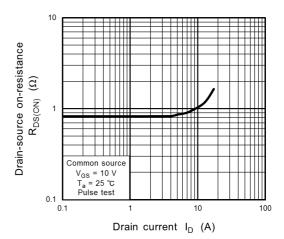
Fig. 8.6 R<sub>DS(ON)</sub> - I<sub>D</sub>
