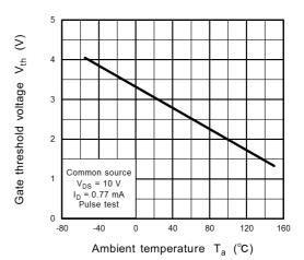
Fig. 8.10 V<sub>th</sub> - T<sub>a</sub>
