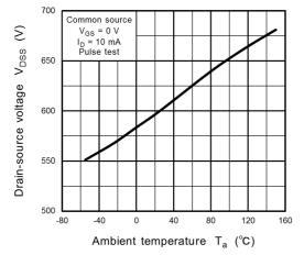
Fig. 8.5 V<sub>DSS</sub> - T<sub>a</sub>
