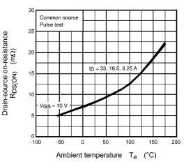
Fig. 8.6 R<sub>DS(ON)</sub> - T<sub>a</sub>
