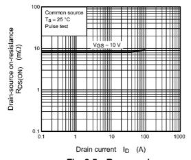
Fig. 8.5 R<sub>DS(ON)</sub> - I<sub>D</sub>
