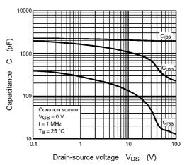
Fig. 8.8 Capacitance - V<sub>DS</sub>
