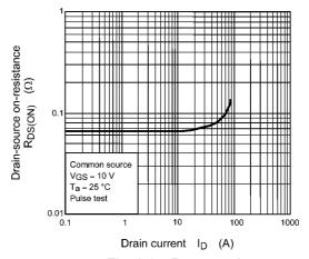
Fig. 8.6 R<sub>DS(ON)</sub> - I<sub>D</sub>
