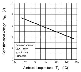
Fig. 8.11 V<sub>th</sub> - T<sub>a</sub>
