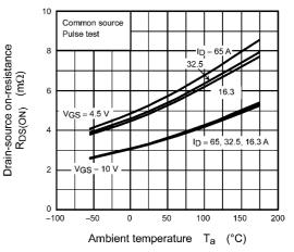
Fig. 8.6 R<sub>DS(ON)</sub> - T<sub>a</sub>
