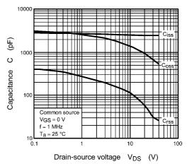
Fig. 8.8 Capacitance - V<sub>DS</sub>
