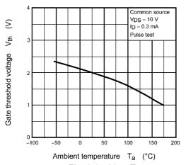
Fig. 8.9 V<sub>th</sub> - T<sub>a</sub>
