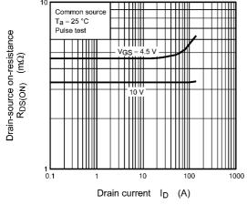
Fig. 8.5 R<sub>DS(ON)</sub> - I<sub>D</sub>
