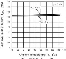
Fig. 12.2.7 I<sub>DDL</sub> - T<sub>a</sub>
