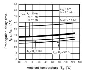
Fig. 13.2.11  $t_{pHL}$ ,  $t_{pLH}$  -  $T_a$
