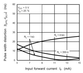
Fig. 13.2.16 |t<sub>DHL</sub> - t<sub>DLHI</sub> - I<sub>F</sub>
