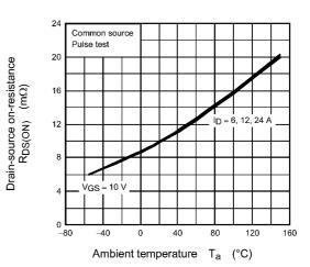
Fig. 8.6 R<sub>DS(ON)</sub> - T<sub>a</sub>
