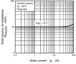
Fig. 8.5 R<sub>DS(ON)</sub> - I<sub>D</sub>
