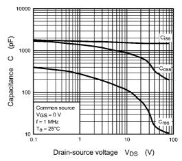
Fig. 8.8 Capacitance - V<sub>DS</sub>
