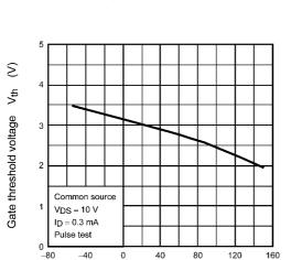
Ambient temperature  $T_a$  (°C) Fig. 8.9  $V_{th}$  -  $T_a$
