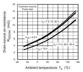
Fig. 8.9 R<sub>DS(ON)</sub> - T<sub>a</sub>
