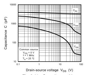
Fig. 8.11 Capacitance - V<sub>DS</sub>
