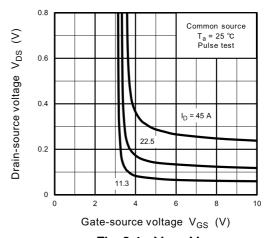
Fig. 8.4  $V_{DS}$  -  $V_{GS}$
