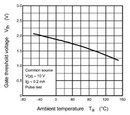
Fig. 8.9 V<sub>th</sub> - T<sub>a</sub>
