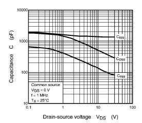
Fig. 8.8 Capacitance - V<sub>DS</sub>
