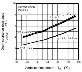
Fig. 8.6 R<sub>DS(ON)</sub> - T<sub>a</sub>
