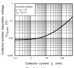
Fig. 6.3 V<sub>CE(sat)</sub> - I<sub>C</sub>
