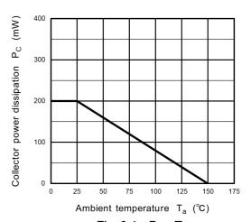
Fig. 6.4 P<sub>C</sub> - T<sub>a</sub>
