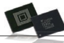
e・MMC™は、コントローラ搭載型のNAND型フラッシュメモリで、内部でエラー訂正、ウェアレベリング、不良ブロック管理などの制御を行っています。インタフェースが高速メモリカード規格のJEDEC/MMCA Ver. 5.0/5.1に準拠しており、ユーザーはNAND型フラッシュメモリ特有の制御を必要とせず、組み込みストレージデバイスとして容易に機器に導入できます。
