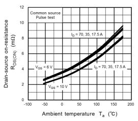
Fig. 8.9 R<sub>DS(ON)</sub> - T<sub>a</sub>
