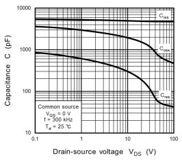
Fig. 8.13 Capacitance - V<sub>DS</sub>
