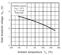
Fig. 8.12 V<sub>th</sub> - T<sub>a</sub>
