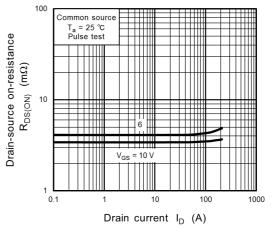
Fig. 8.8 R<sub>DS(ON)</sub> - I<sub>D</sub>
