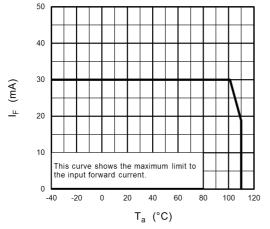
Fig. 14.1 I<sub>F</sub> - T<sub>a</sub>
