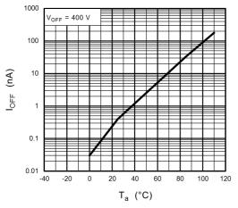
Fig. 14.9 I<sub>OFF</sub> - T<sub>a</sub>
