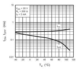
Fig. 14.8 t<sub>ON</sub>, t<sub>OFF</sub> - T<sub>a</sub>
