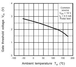
Fig. 8.12 V<sub>th</sub> - T<sub>a</sub>
