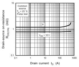
Fig. 8.8 R<sub>DS(ON)</sub> - I<sub>D</sub>
