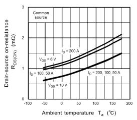
Fig. 8.9 R<sub>DS(ON)</sub> - T<sub>a</sub>
