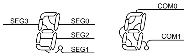
図 13-7 COM, SEG 端子接続例
