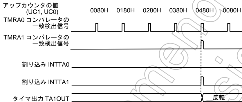
図 3.12.19 16 ビットタイマモードによるタイマ出力
