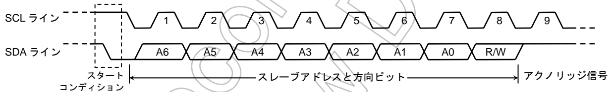
図 3.15.10 スタートコンディションの発生とスレーブアドレスの発生
