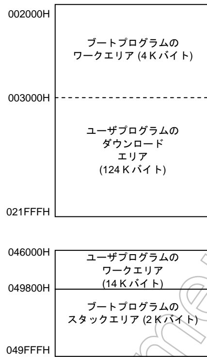
図 3.4.3 ブートプログラムの内蔵 RAM 使用方法
