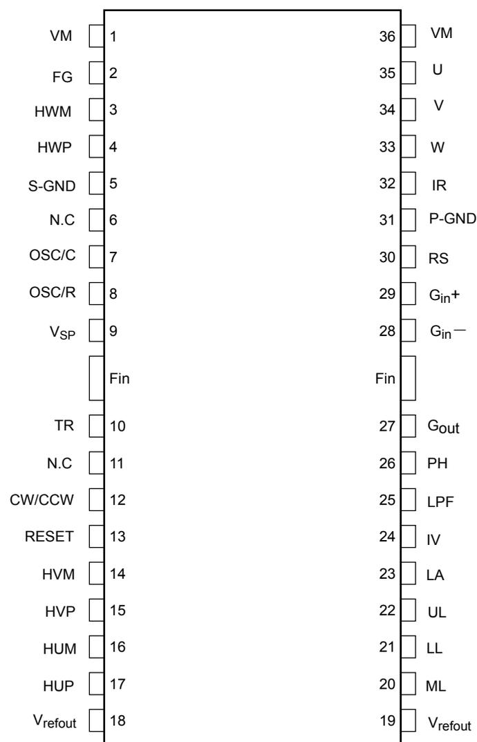
注: 1ピンと36ピン、18ピンと19ピンはIC内部のフレームで接続されています。
