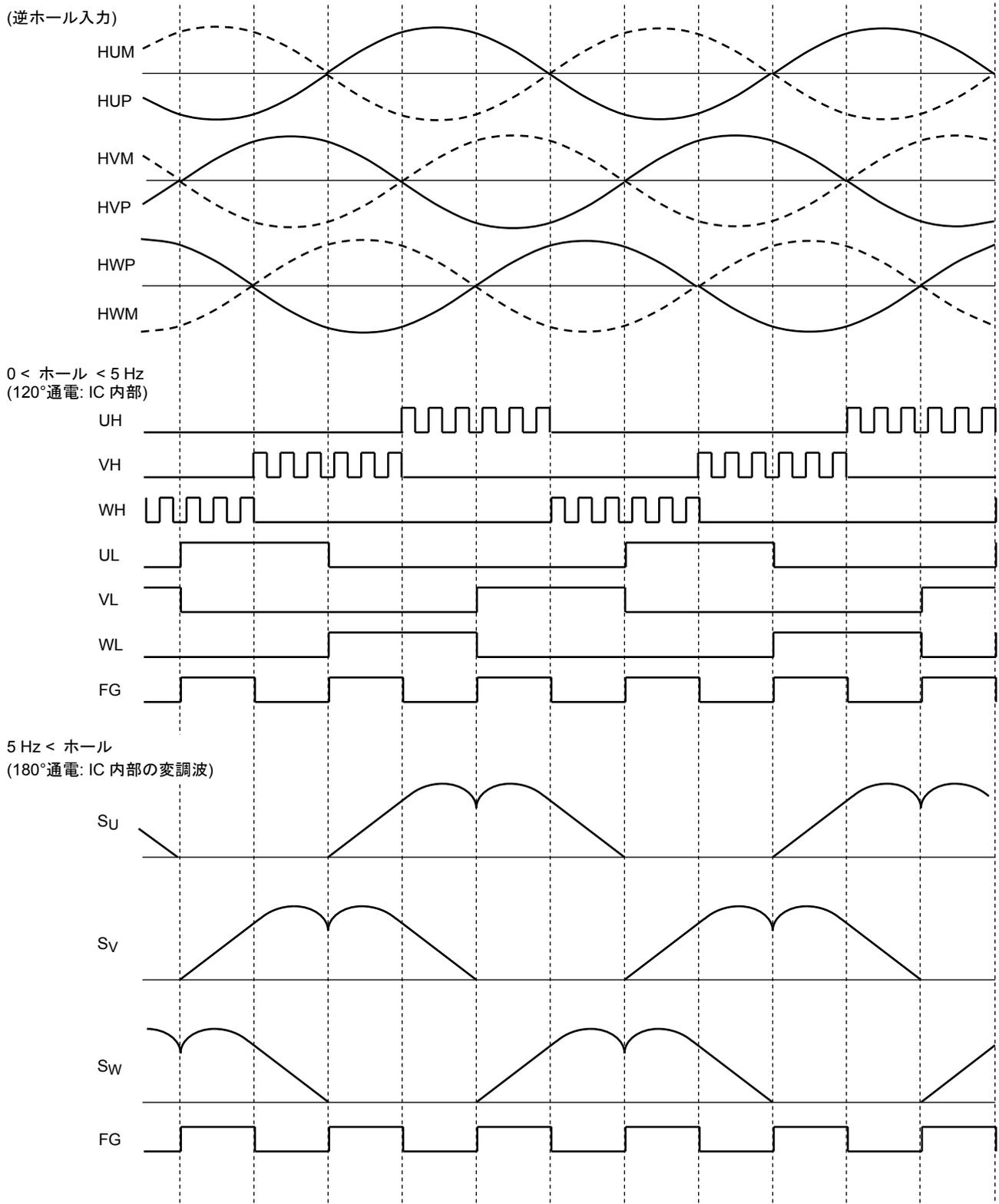
\*: ホール信号が 2.5 Hz 以上では、LA 端子に従い進角補正機能が動作します。
