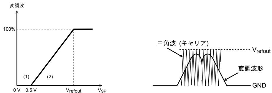
注: 変調波形が最大となる  $V_{refout}$  電圧を 100%としております。
