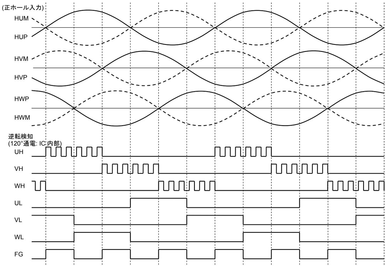
\*: CW/CCW = High で正ホール信号が入力された場合は、進角 0°の 120°通電で駆動します。(逆風動作)
