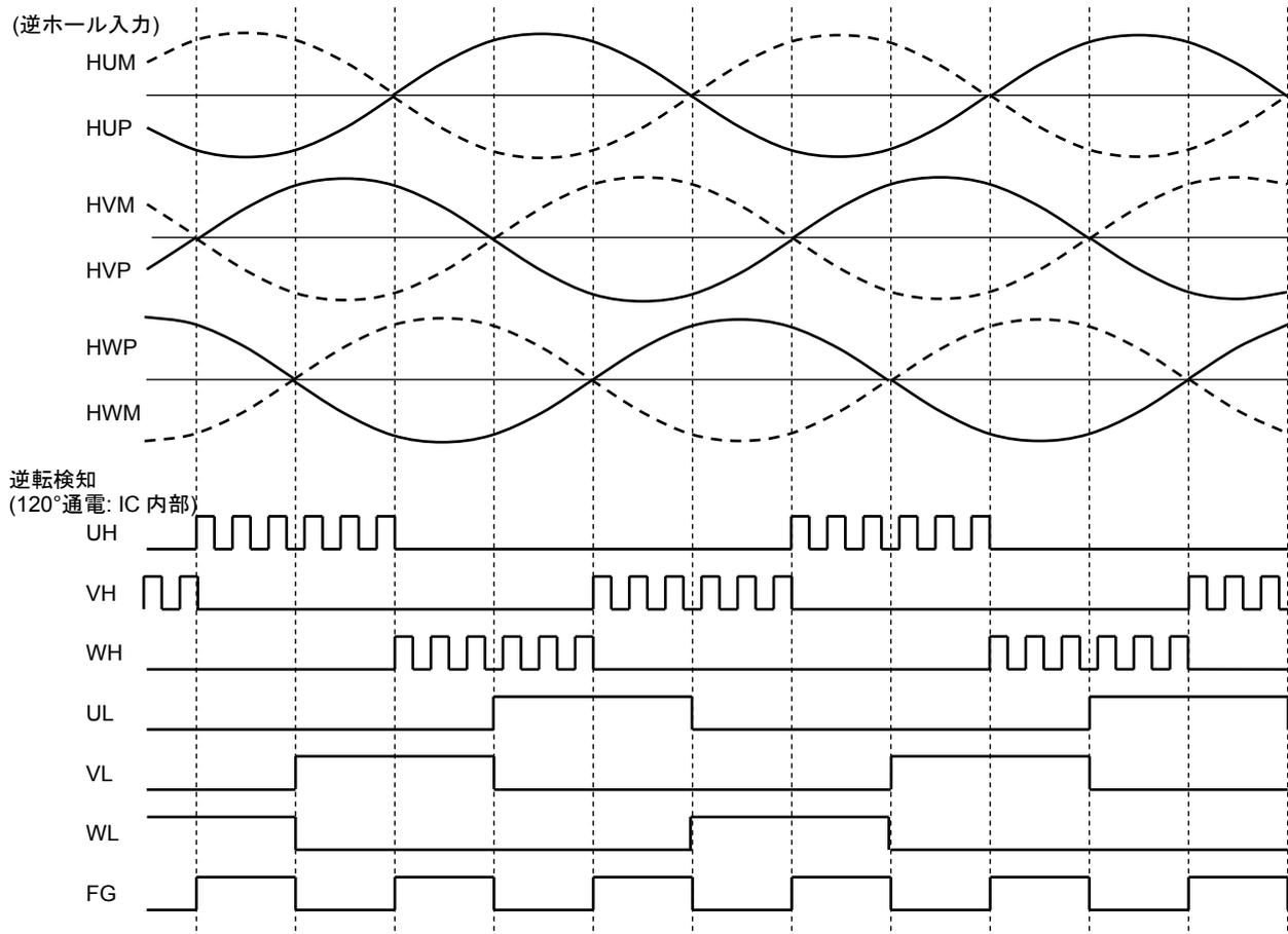
\*: CW/CCW = Low で逆ホール信号が入力された場合は、進角 0° の 120° 通電で駆動します。(逆風動作)
