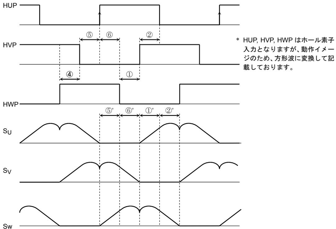
上図において、HU: ↑ から HW: ↓ までの時間①の 1/32 の時間幅で、変調波形の①' データは進み、同じく、HW: ↓ から HV: ↑ までの時間②の 1/32 の時間幅で、②' のデータは進みます。
