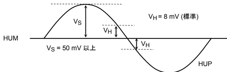
\*: 50 mVpp 以上あれば、ホールアンプは動作しますが、各相間の 60°時間幅を安定させるため、出来る限り振幅を上げてください。(推奨;200 mVpp 以上)
