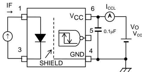
図 4 ICCH 測定回路
