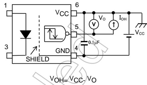
図 3 ICCL 測定回路
