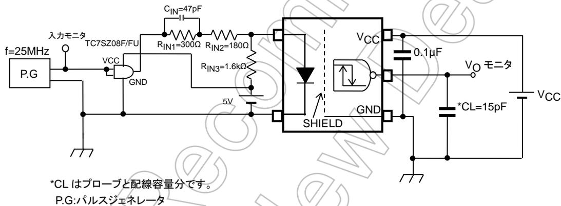
図7 コモンモードノイズ除去電圧測定回路、波形
