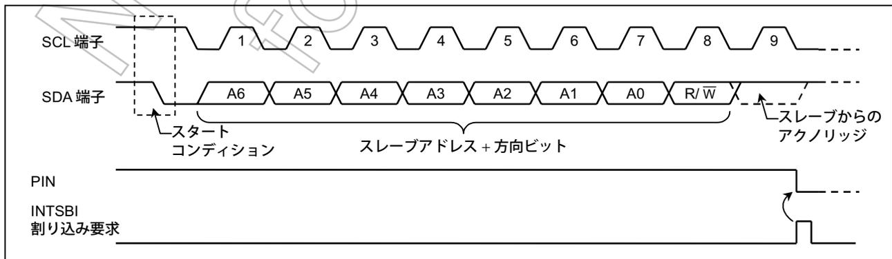
図 2.10.11 スタートコンディションとスレーブアドレスの発生
