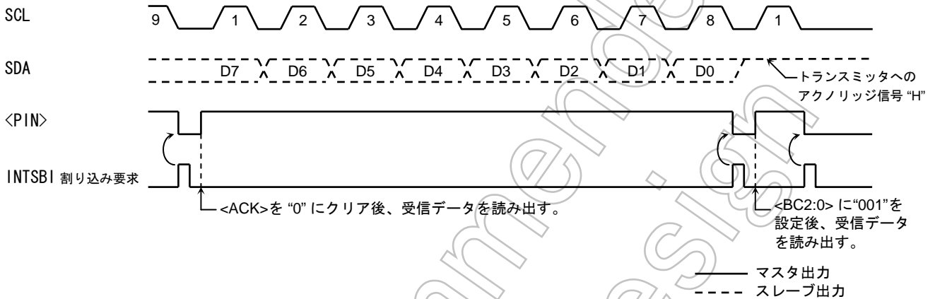
図 14.6.3.3 マスタレシーバモード時、データの送信を終了させるときの処理
